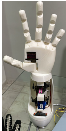
Imagen 3. Impresión de mano con servos
