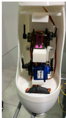
Imagen 4. Componentes internos de la mano
