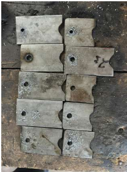
Figura 29.- Fabricación de anclajes del tren motriz.
