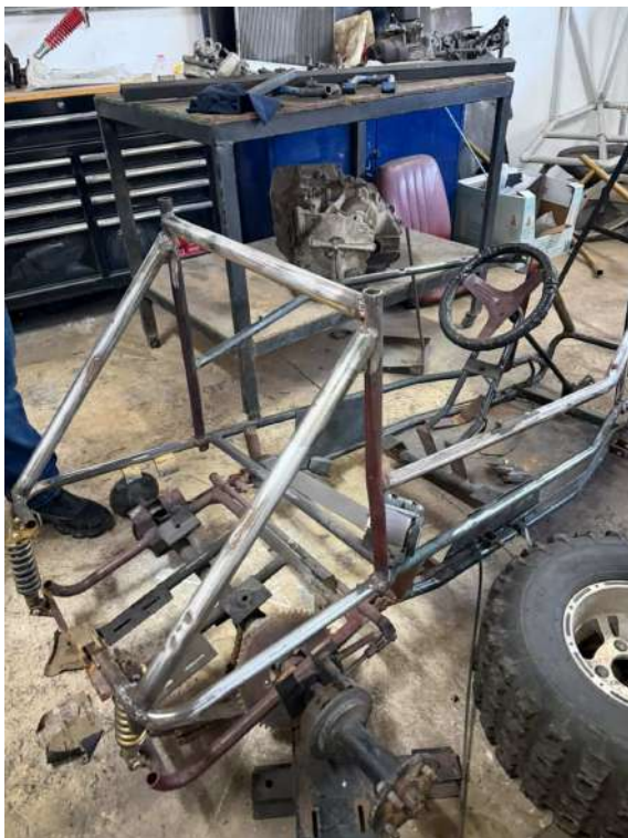
Figura 32.- Chasis lijado y sin pintura.
