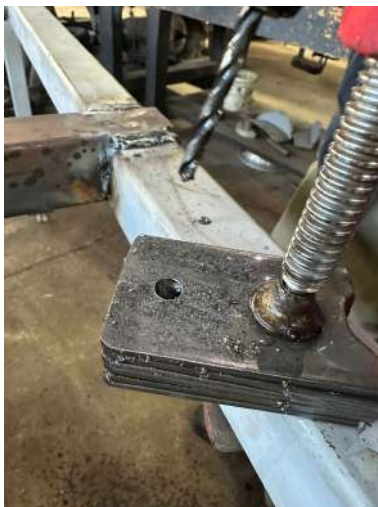
Figura 29.- Fabricación de anclajes del tren motriz.
