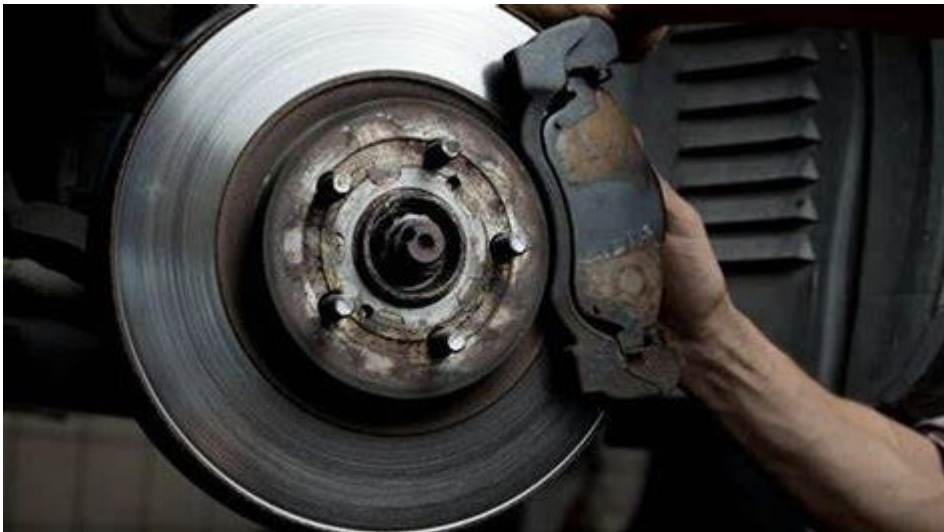
Figura 1. Imagen ilustrativa de una pastilla de freno desgastada.
