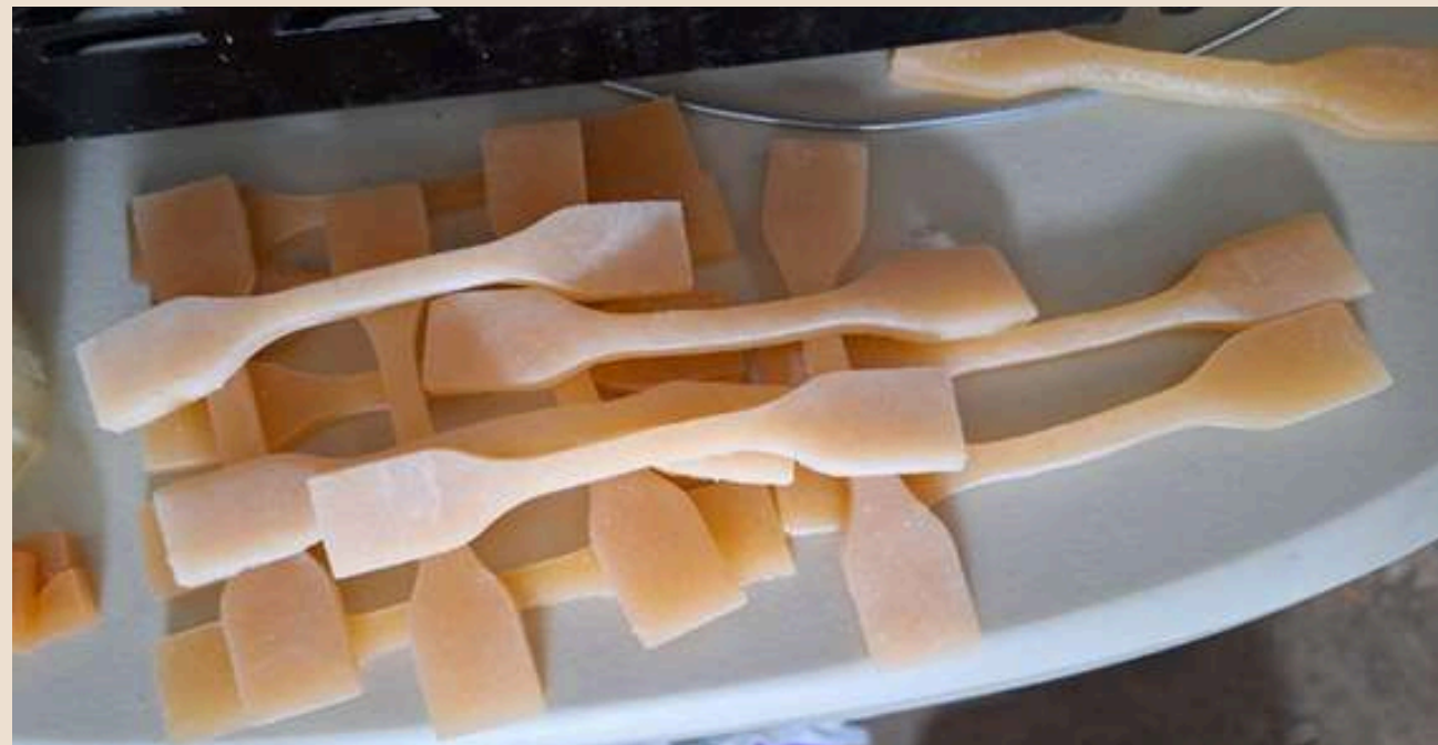
Figura 2. Probetas obtenidas. Fotografía de las probetas una vez fuera del molde.
