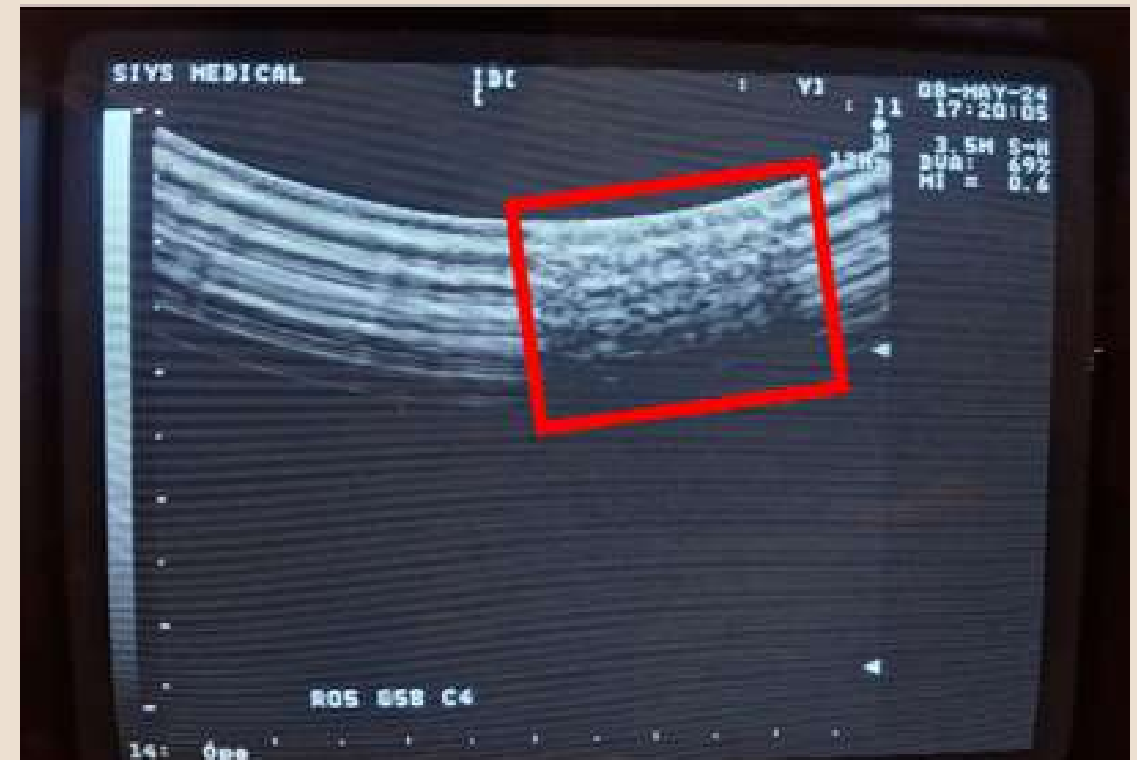
Figura 5. Imagen obtenida por el equipo de ultrasonido. La parte oscura inferior es donde se ubicó la muestra de material, el área blanca superior es la parte libre del transductor.
