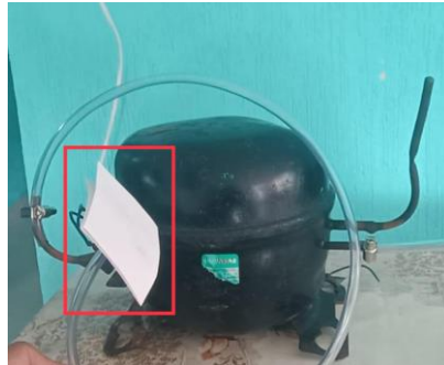
Imagen 4. Se observa la presión que ejerce la succión de aire de la bomba sobre el papel (cuadro rojo), el cual es ligero, similar a un papel filtro.
