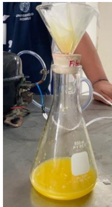
Imagen 5. Mediante el uso de un Kitasato, papel filtro, un tapón de goma y de un embudo de cristal, se hizo la prueba, demostrando que todo el líquido filtrado no está atrapado entre el embudo y el papel. Además, se observa una sombra en el embudo con papel filtro, de toda la pulpa residual.
