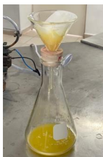
Imagen 6. Observando el embudo, hay líquido atrapado entre este y el papel filtro, demostrando que la velocidad de filtración es menor si no se usa la bomba de vacío.
