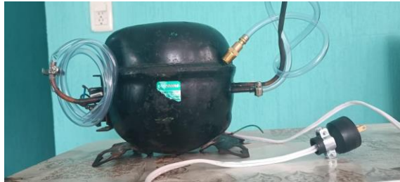
Imagen 3. El correcto ensamblado de la bomba, permitirá una correcta filtración, evitando fugas de aire, además, la buena colocación de las mangueras, adaptadores es parte fundamental para evitar que se desmonten, evitando accidentes posteriores.
