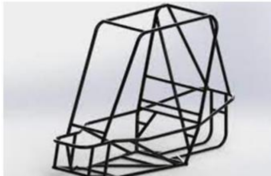
Figura 3: Ejemplo de chasis tubular tipo “Baja”
