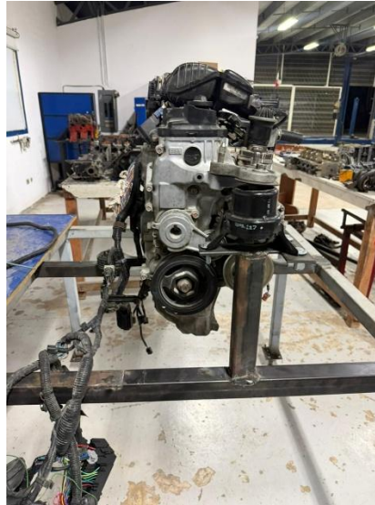
Imagen 37. motor montado en base
