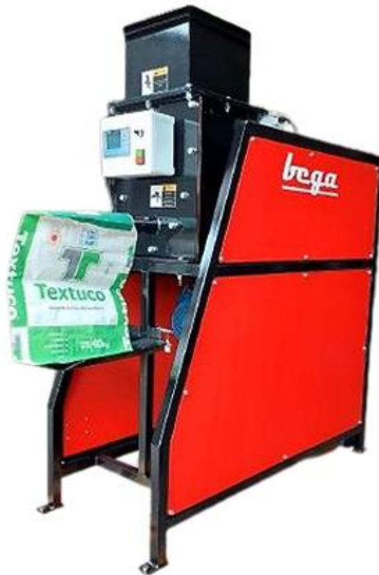
Imagen 3. Ensacadora electrónica Bega de dosificación programable de uso rudo
