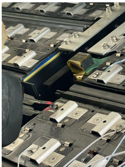
Imagen 51: Proceso de soldadura de conexiones en banco de baterías, parte 3.
