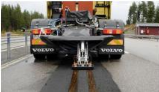
Imagen 13: Sistema de alimentación por suelo a un vehículo de carga híbrido
