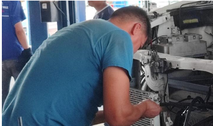
Imagen 62: Revisión de líneas alta y baja presión del sistema de aire acondicionado
