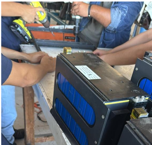
Imagen 47: Elaboración de base donde irán colocadas las baterías
