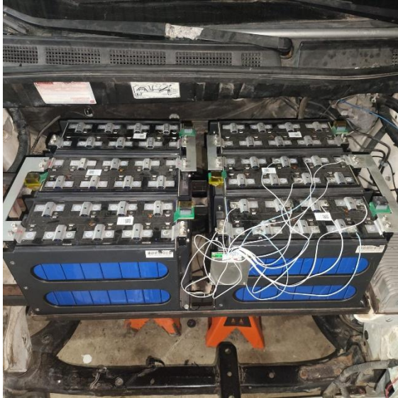
Imagen 48: resultado de la base con las baterías ya montadas
