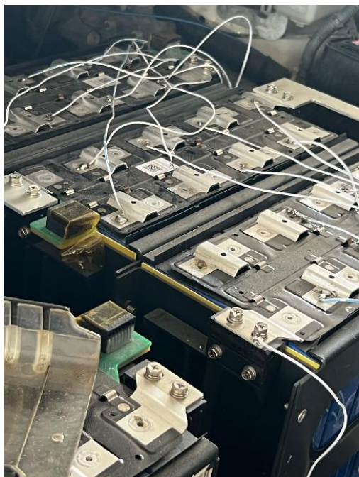
Imagen 50: Proceso de soldadura de conexiones en banco de baterías, parte 2.
