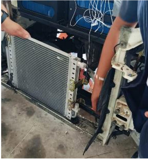
Imagen 60: Toma de medidas e instalación preliminar, para la construcción de la base del condensador, parte 1.
