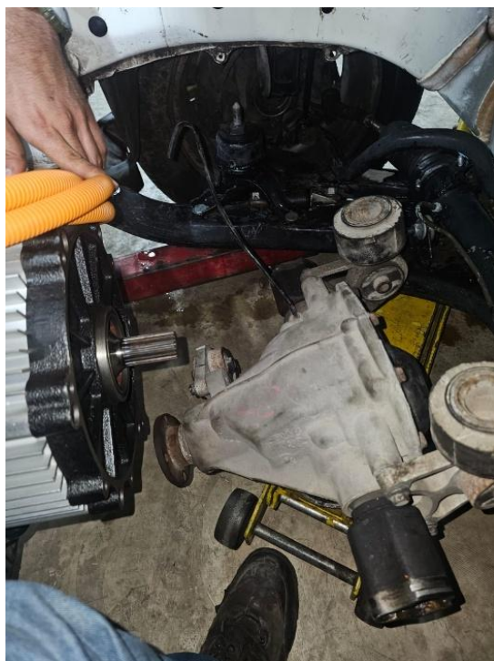
Imagen 45: acomodamiento del motor eléctrico dejándolo al nivel con el sistema de transmisión.
