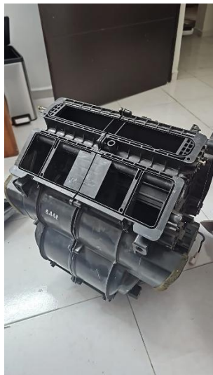
Imagen 55: Componentes físicos desmontados (cabina de aire y difusor).
