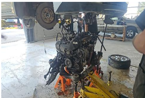
Imagen 36: Extracción del motor del Vehículo Toyota Sienna 2008
