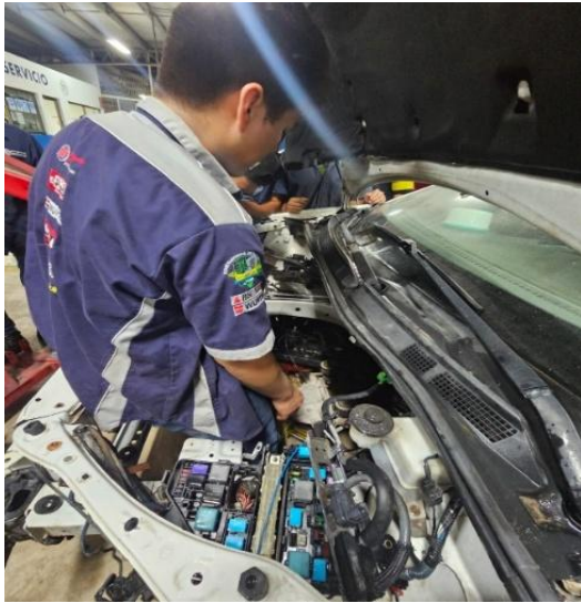
Imagen 42: Verificación del área en donde se instalará el motor eléctrico
