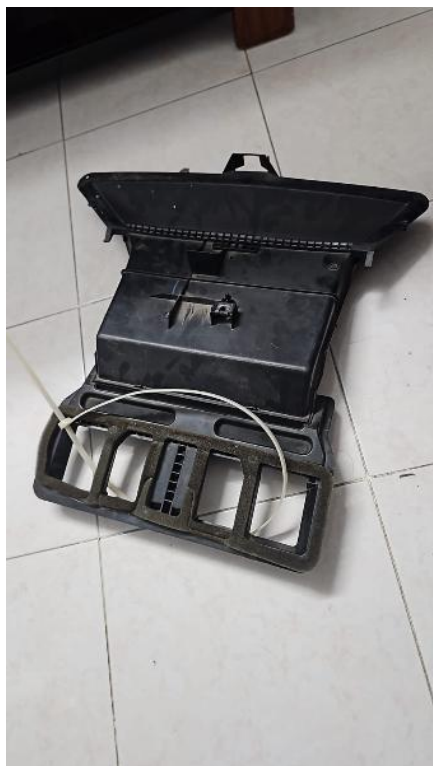
Imagen 56: Componentes físicos desmontados (cabina de aire y difusor).
