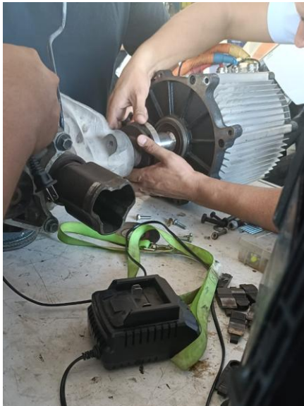
Imagen 64: Desmontaje del elemento de acoplamiento entre el motor y el diferencial
