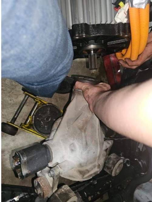
Imagen 46: Acople de motor eléctrico a diferencial
