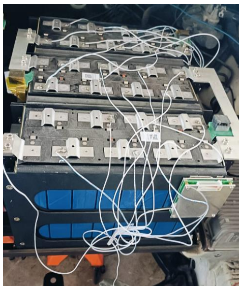
Imagen 52: Baterías ya conectadas al BMS
