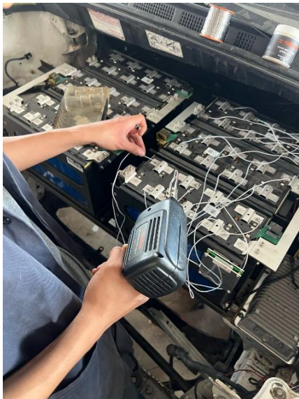
Imagen 49: Proceso de soldadura de conexiones en banco de baterías, parte 1.
