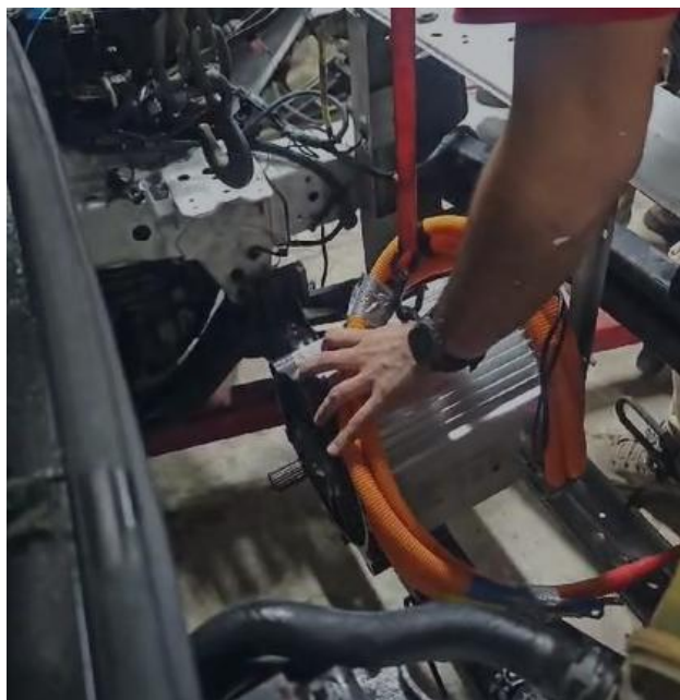
Imagen 44: acomodamiento del motor eléctrico
