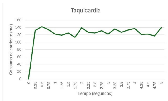
Gráfica 7. Corriente consumida en mA por cada servomotor en el estado de taquicardia del simulador.
