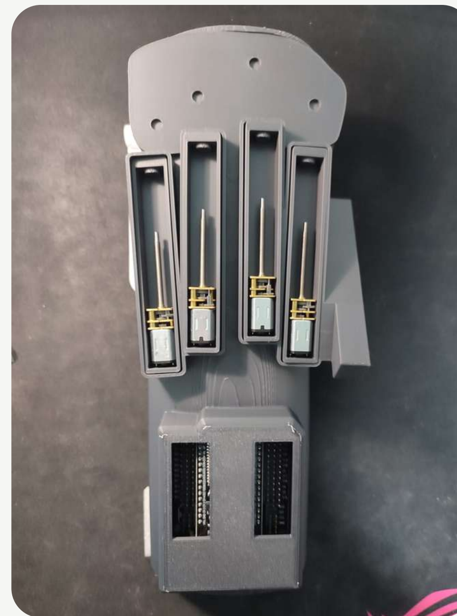
Prototipo con la carcasa de protección para el ESP32
