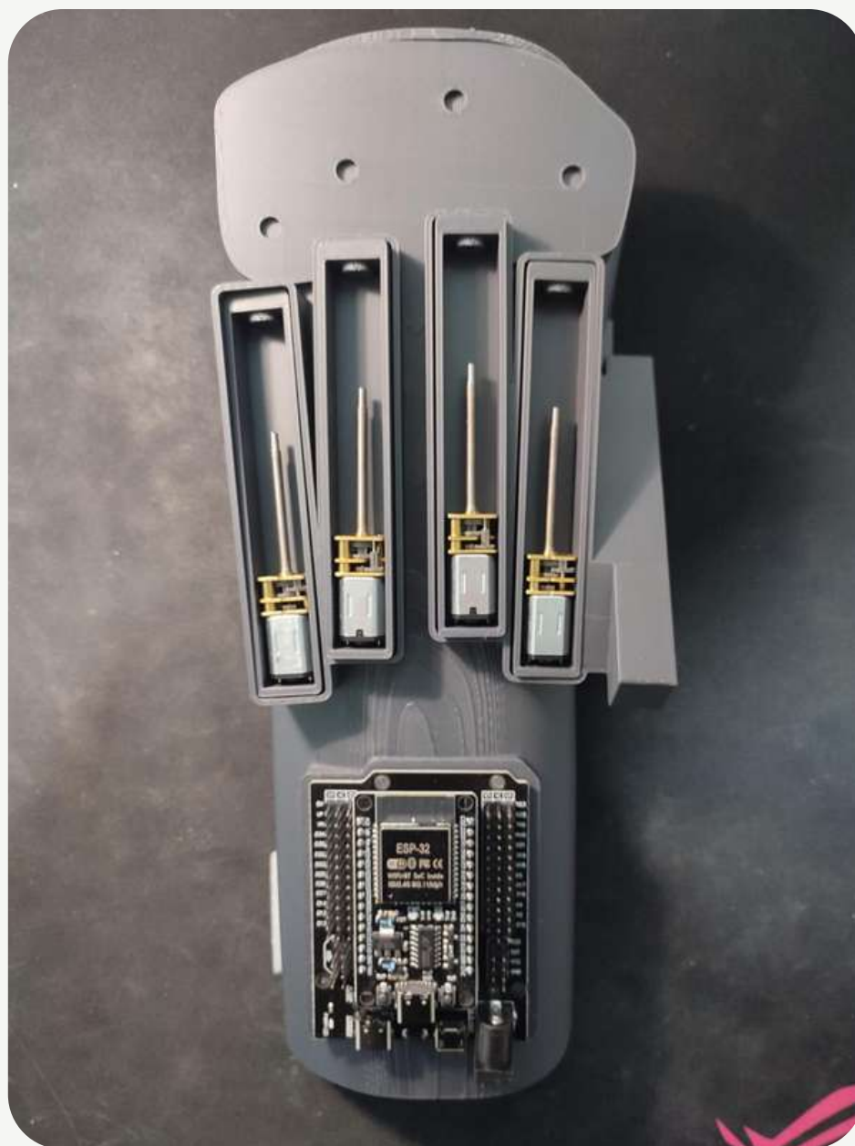
Prototipo con los motores y el ESP32 incorporado
