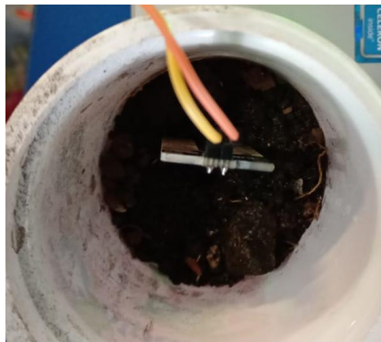
Ilustración 6. Sensor HW-080 en la tierra mojada
