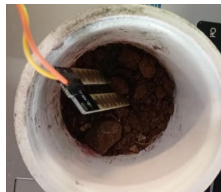
Ilustración 5. Sensor HW-080 en la tierra seca
