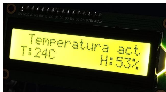
Ilustración 4. Display con protocolo I2C con los datos del DHT11
