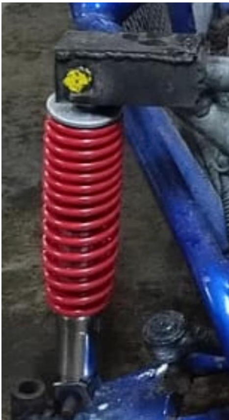
Imagen 8. Amortiguador con soporte de soleras soldado en la parte superior.
