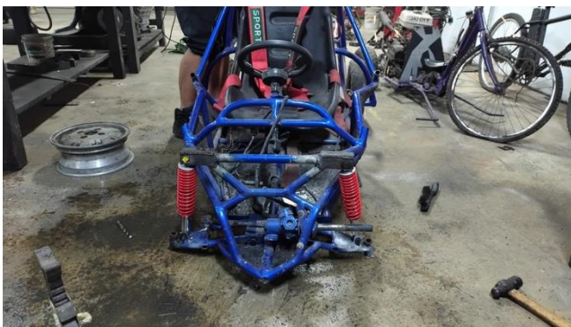
Imagen 9. Todoterreno con suspensión delantera adaptada.
