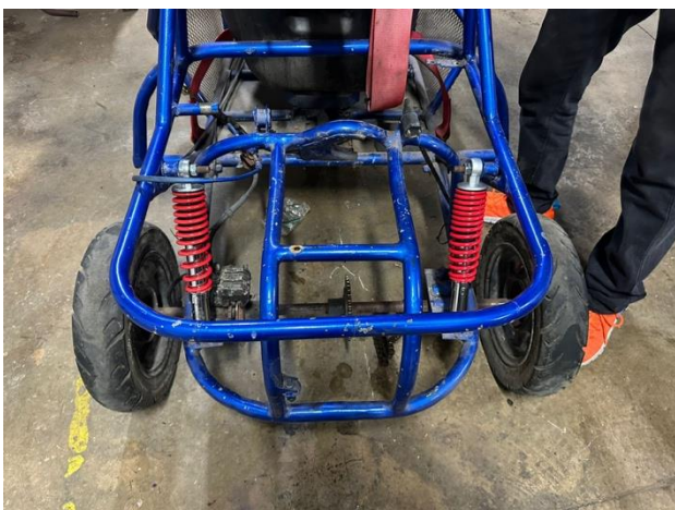
Imagen 10. Todoterreno con suspensión trasera adaptada.
