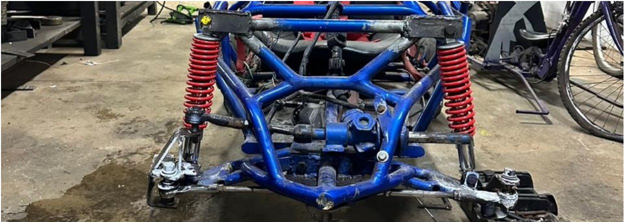
Imagen 13. Amortiguadores delanteros montados con sus soportes superiores hechas por el equipo.
