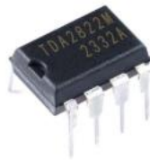
Imagen 3.2.6. circuito integrado amplificador de audio de bajo consumo y doble canal
