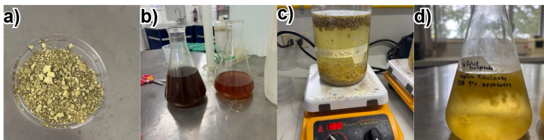
Figura 2. Proceso de extracción de pectina de cáscaras de naranja. Incluyendo la preparación de la materia prima (a), despigmentación (b), hidrólisis ácida (c), y precipitado (d).
