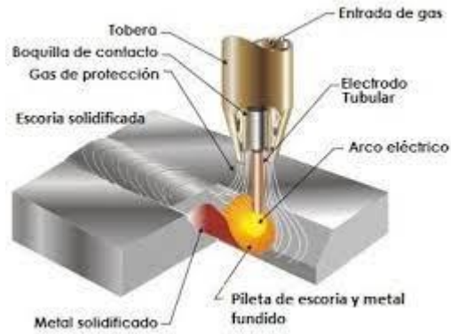
Imagen 12 -soldadura FCAW
