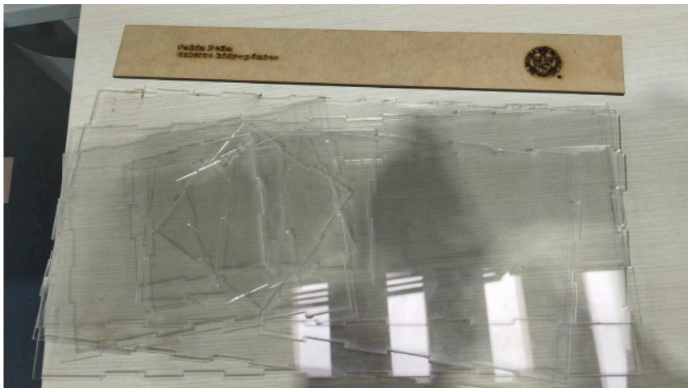
Corte de las piezas del tanque principal y secundario
