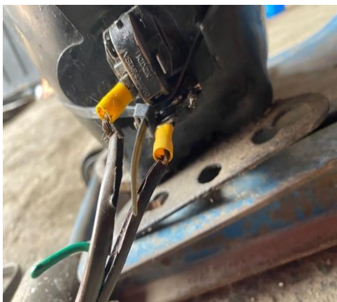
Figura 1: Verificación del buen funcionamiento del protector térmico.
