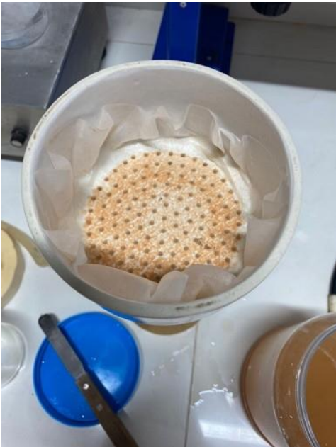
Figura 8: Sólido que se acumula en el papel filtro durante el proceso de filtración al vacío.
