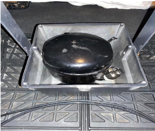
Figura 5: La carcasa después del corte con las salidas de aire y entrada de vacío ya funcionales.
