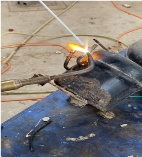
Figura 2: Soldadura con varillas de bronce y plata.
