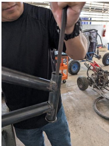
Ilustración 72 y 73. Adaptación del manubrio.
