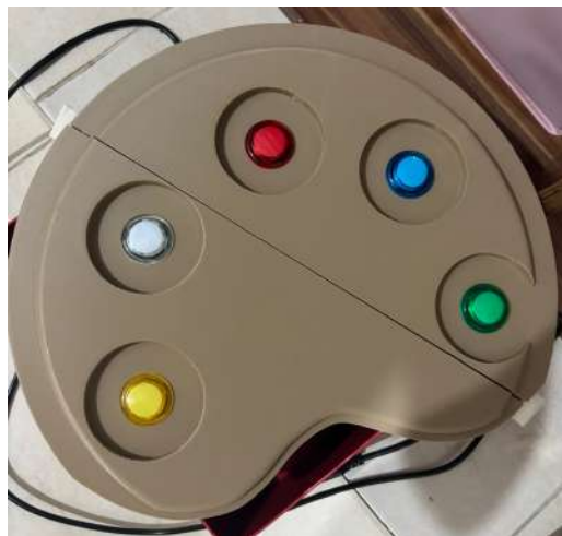
Figura 2. Panel impreso, con los botones integrados
