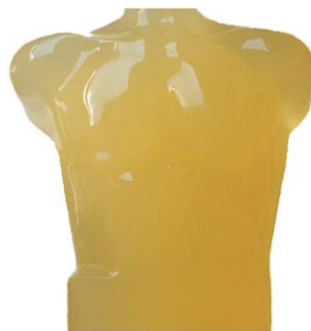
Fig.1.0 Simulador de gel balístico.
