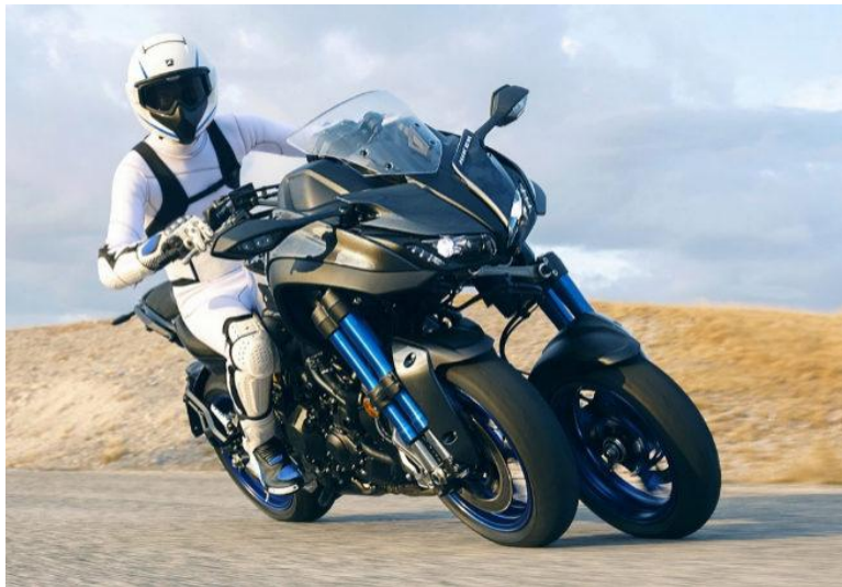
Imagen 2: Motocicleta con configuración Tadpole.
