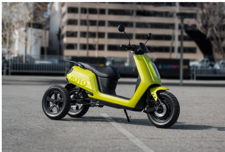
Imagen 1: Motocicleta con configuración Delta.
