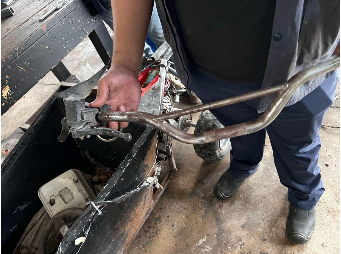
Imagen 21: Manillar que se utilizará para la adaptación del freno.
