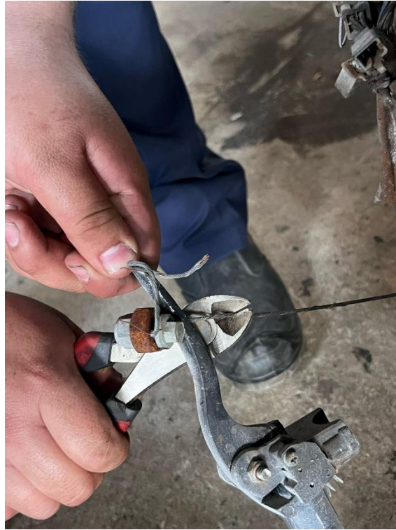
Imagen 22: Corte del chicote de freno para la reubicación del componente.
