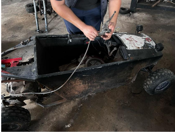
Imagen 23: Adaptación del freno al manillar.
