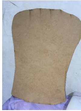
Figura 11. Diseño en MDF de base para el simulador. Este torso fue cortado en el centro de innovación de la universidad, utilizando un sistema de control del equipo de corte laser para dibujar la silueta en el MDF.
