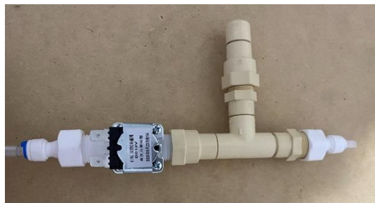
Figura 9. Circuito de PVC. Realizado con tapas, conectores hembra y macho y tubo PVC de \frac{1}{2} in para permitir el desagüe por medio de las tapas superiores de la T.
