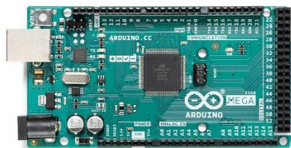
Figura 8. Microcontrolador Arduino Mega. Tiene 54 pines de entrada/salidas digitales (de los cuales 15 se pueden usar como salidas PWM), 16 entradas analógicas, 4 UART (puertos serie de hardware), un oscilador de cristal de
