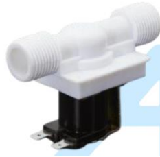
Figura 4. Electroválvula solenoide direccional 12vdc normalmente cerrada 0.02mpa-0.8mpa. Controla el flujo de fluido utilizando el flujo de electrones. La válvula tiene una disposición de junta en el interior. El líquido sólo puede fluir en una dirección (AG Electrónica, 2023).
