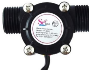
Figura 5. Sensor de flujo YF-S201. Tiene tres cables para su conexión, rojo y negro para la alimentación y amarillo para la salida de los pulsos. La salida de pulsos es una onda cuadrada cuya frecuencia es proporcional al caudal. El factor de conversión de frecuencia (Hz) a caudal (l/min) varía entre modelos y depende de la presión, densidad e incluso del mismo caudal (Naylamp Mechatronics SAC, 2023).
