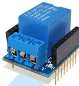
Figura 7. Módulo relevador para wemos. Permite controlar dispositivos eléctricos que funcionan con un voltaje de CA de hasta 250 VCA o 30 VCD (AG Electrónica, 2019).
