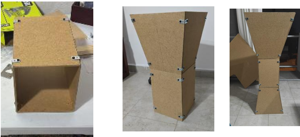
Figura 11. Armado de cono de admisión y canal de pruebas
