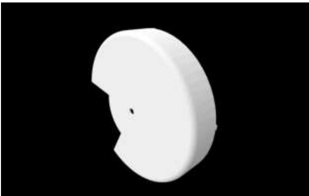
Fig.# Tapa: diseño 3D de la tapa con abertura por la que se obtienen las pastillas.
