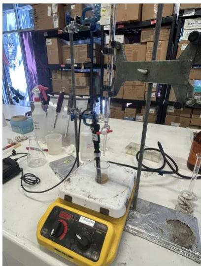
*Para iniciar se monta el soporte, colocando el agitador por debajo de la bureta, se tiene que colocar de manera que el potenciómetro se encuentre dentro de la solución evitando que el imán golpee el electrodo por lo que la potencia de agitación es baja.*
