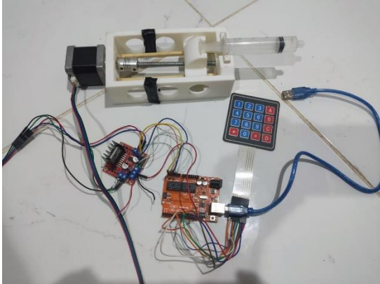
Ilustración 5. Sistema para el suministro de la solución (bomba de infusión), controlada por un Keypad 4x4
