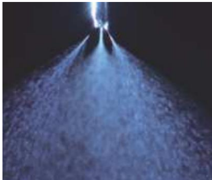
Ilustración 2. Imagen de varios jets cuando se produce electrospinning
