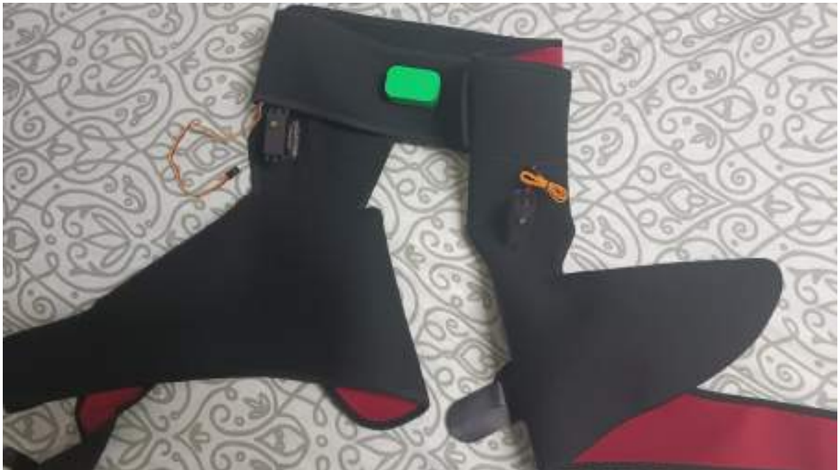
imagen 1.3 Incorporación de los sensores y carcasa al soporte
