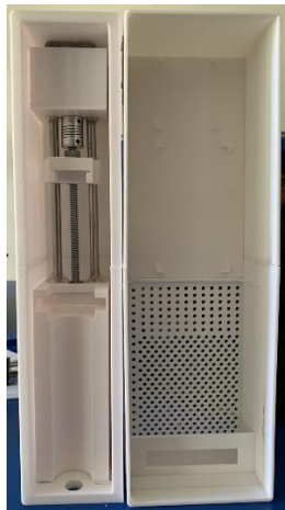
Ilustración 1. Se presenta la carcasa de la bomba de infusión impresa por medio de impresión 3D
