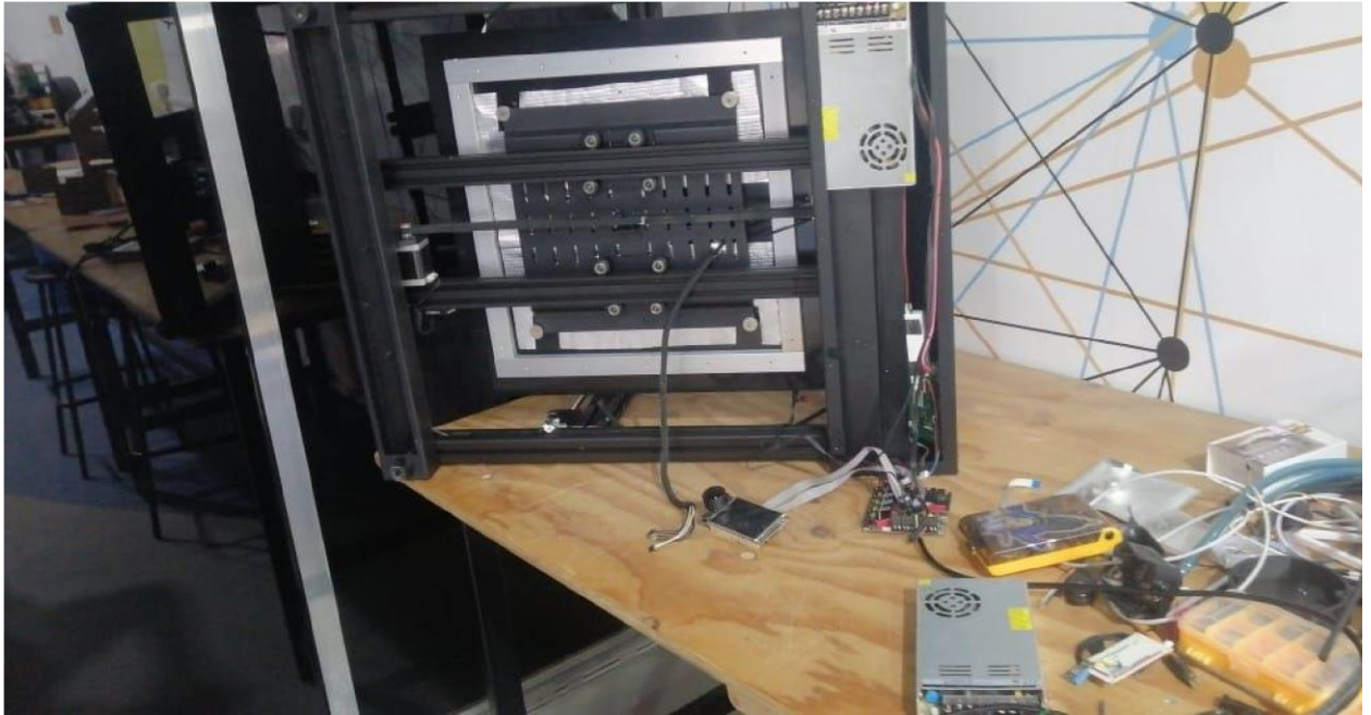
Figura 9. Vista frontal de la conexión agregada de del display con el potenciómetro junto con el regulador para la activación de la tarjeta madre.
