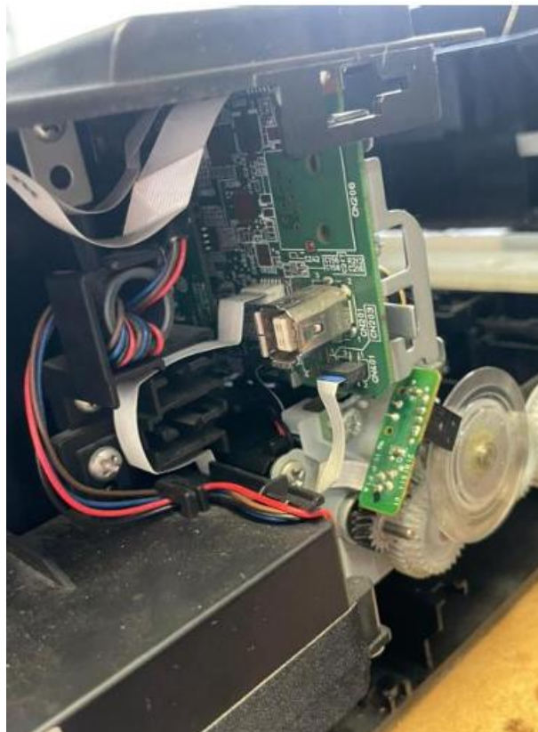
Figura 4. Componentes identificados para retirar durante el desarmado de la impresora convencional: placa electrónica original, cables planos (flex), engranajes y sensores no reutilizables.
