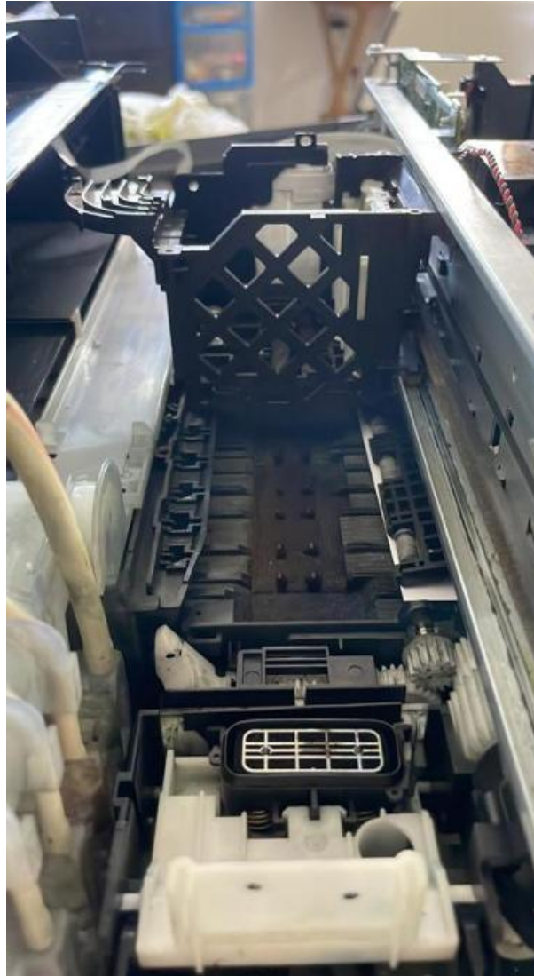
Figura 6. Carro del cabezal y barra de guía lineal del eje X, reutilizados para el desplazamiento horizontal del mecanismo de embossing.
