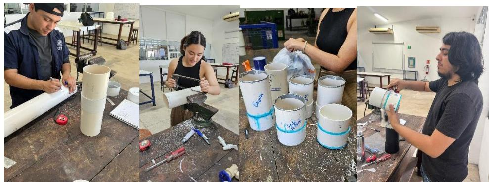
Para la salida del agua filtrada, se incorporó un reductor que permitió la correcta adaptación de los diámetros de las tuberías. Además, se utilizaron conectores de PVC, tanto sanitario como hidráulico, para garantizar una conexión eficiente entre las distintas secciones del sistema. Finalmente, se instaló una llave de paso, diseñada para controlar el flujo del agua, permitiendo su regulación según fuera necesario.
