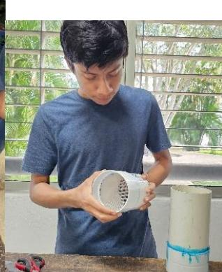
En el extremo opuesto de cada tubo, se aplicó cinta adhesiva para reforzar el sellado y evitar cualquier filtración no deseada. Con esta estructura, los cartuchos del material filtrante quedaron listos para cumplir su función en el sistema.
