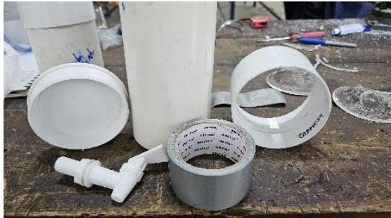
La construcción del filtro de aguas grises comenzó con la preparación de la estructura de los cartuchos del material filtrante. Para ello, se utilizaron tubos de PVC, que fueron cortados con una seguita para obtener las dimensiones adecuadas, asegurando que estas quedaran bien sujetas para evitar el paso de impurezas. Se recortó el exceso de malla para garantizar un ajuste preciso y se sellaron las uniones con pegamento para PVC, asegurando una conexión firme y sin fugas.
