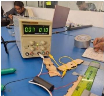
Al realizar la prueba con un voltaje de 1V y un amperaje de 0.07A se pudo generar un arco eléctrico que se formó a partir de una distancia máxima de 0.5mm.
