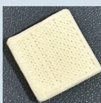
El andamio que se diseñó fue un andamio de 4 niveles con 0,3 mm de espacio entre cada nivel. El primer nivel tenía filamentos diseñados en un ángulo de 90 grados, el segundo nivel en un ángulo de 45 grados, el tercer nivel en un ángulo de -45 grados y el nivel final en 0 grados. Había un espacio de 0,6 mm y luego se repetirían las 4 capas.
