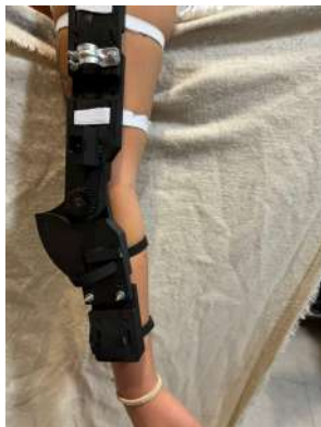
Figura 7.- Rangos de movimientos; a) Exoesqueleto montado en posición de extensión de brazo; b) Esqueleto en posición de flexión casi en un ángulo de 90^\circ grados
