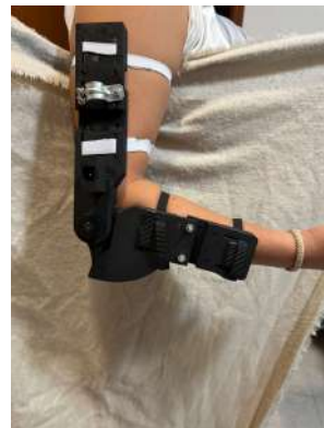
Figura 7.- Rangos de movimientos; a) Exoesqueleto montado en posición de extensión de brazo; b) Esqueleto en posición de flexión casi en un ángulo de 90^\circ grados
