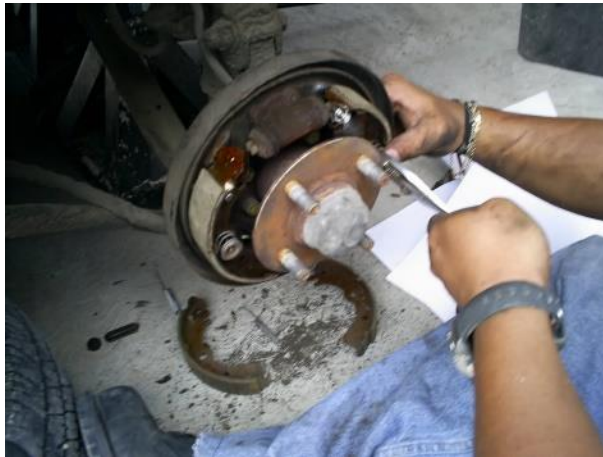
Figura 11 – Apoyo visual cambio de balata del modelo Nissan Tsuru.
