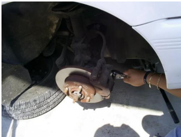
Figura 9 – Apoyo visual cambio de balata del modelo Nissan Tsuru.
