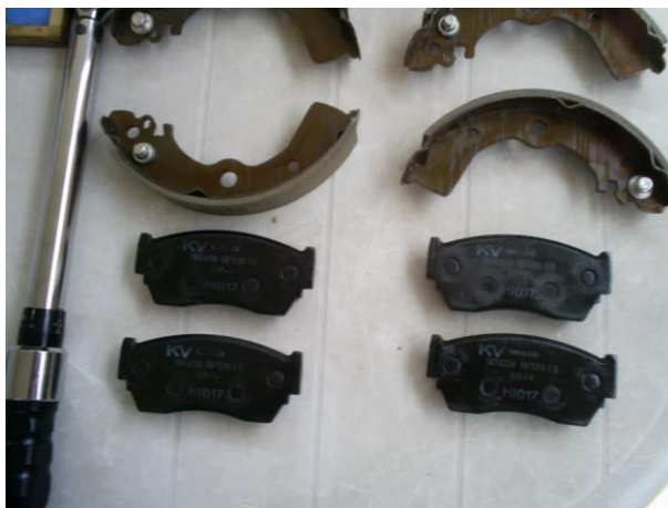
Figura 7 – Apoyo visual cambio de balata del modelo Nissan Tsuru.
