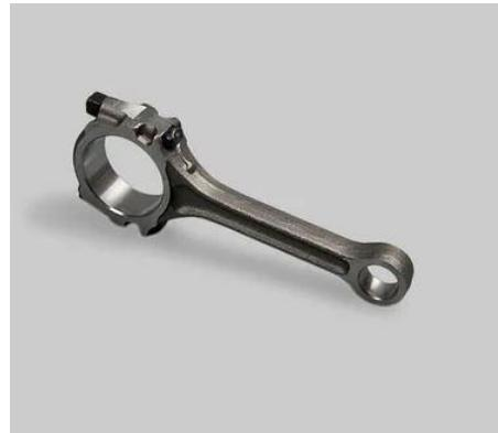
La biela está fabricada con materiales resistentes como acero forjado o aluminio de alta calidad para soportar las altas fuerzas y presiones que se generan durante la combustión. La longitud de la biela determina la relación de compresión del motor, que es la relación entre el volumen de la mezcla de aire y combustible cuando el pistón está en el punto muerto inferior y el volumen cuando está en el punto muerto superior.
