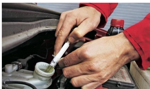
Figura 135 – Revisión del líquido de frenos
