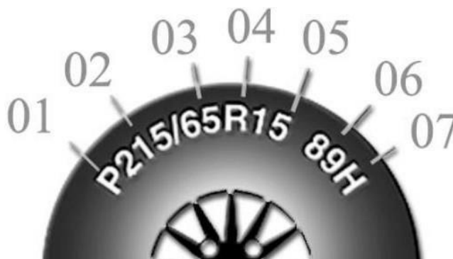
Figura 53 - División de la nomenclatura de una llanta.
