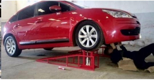
Figura 132 – Vehículo alzado en rampas
