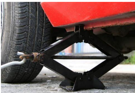
Figura 134 – Colocación de un gato.
