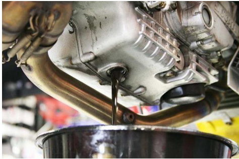
Figura 120 – Vaciado de Aceite
