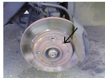
Figura 98.-Tornillos del disco de frenos
