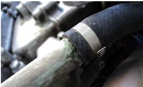
Figura 74 – Inspección de fugas
