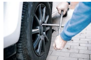
Figura 110.- Extracción de tuercas.
