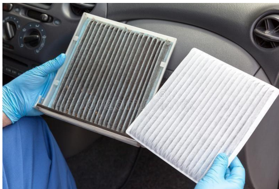
Figura 130 – Comparación entre un filtro usado (izquierda) y uno nuevo (derecha)
