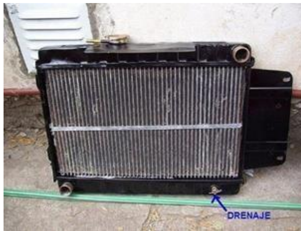
Figura 133 – Localización del puerto de drenaje.
