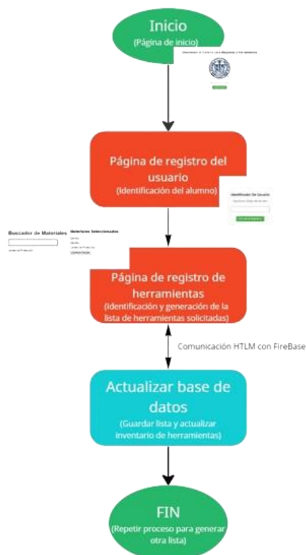
Figura 7. Representación gráfica en forma de diagrama de bloques del funcionamiento general del código y la interfaz.
