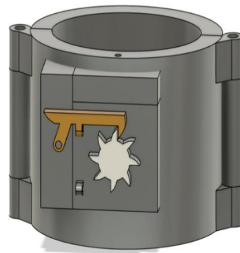
Figura 4. Diseño 3D, muñequera de la órtesis. Fuente: Elaboración propia.
