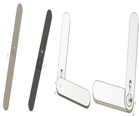
Figura 5. Diseño 3D del mecanismo ubicado en el antebrazo y bíceps de la órtesis. Fuente: Elaboración propia.
