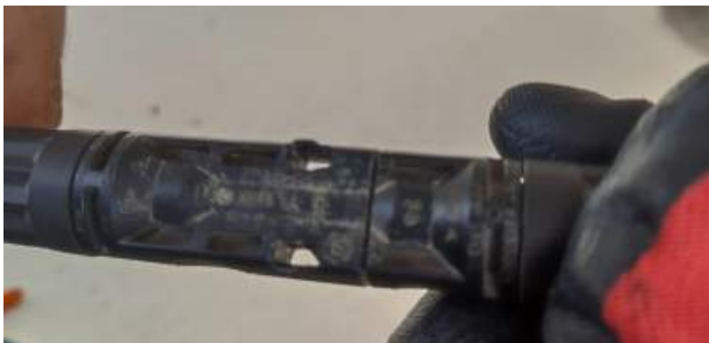
Figura 12. Conexión MC4 después de 1 año
