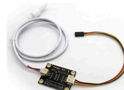
3. **Sensor de pH PH-4502C** (rango 0–14, precisión ±0.1 pH).
