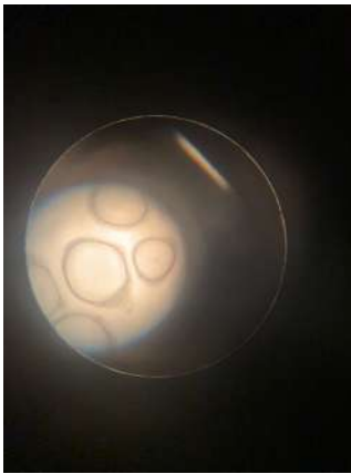
Figura 3: Vista del microscopio de las burbujas atrapadas en la muestra
