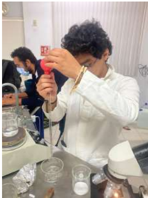
Figura 2: Vertimiento del bórax al silicon en una placa de cristalización
