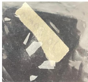
Ilustración 5. Película rota luego a una exposición de 10 minutos con grupos COOH. Fuente: imagen propia.
