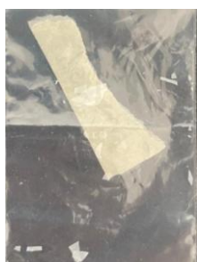
Ilustración 7. Película degradada en su totalidad luego de una exposición de 60 minutos con grupos \text{COOH} . Fuente: imagen propia.
