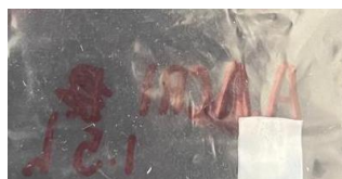
Ilustración 8. Película en buenas condiciones luego de realizarse el injerto AA durante 90 minutos. Fuente: imagen propia
