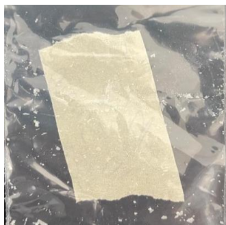
Ilustración 6. Película rota luego de una exposición de 30 minutos con grupos \text{NH}_2 . Fuente: imagen propia.
