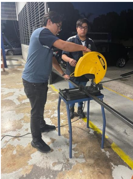
Ilustración 38. Cortando el PTR a la medida adecuada con una cierra circular.
