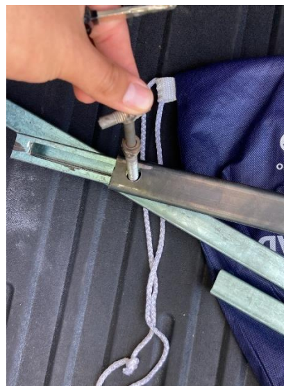
Ilustración 39. Orificio ya realizado de 3/4" para la mariposa.
