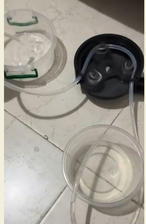
Figura 9. -Preliminar de la bomba peristáltica con flujo de 180ml. Fuente: Elaboracion propia.
